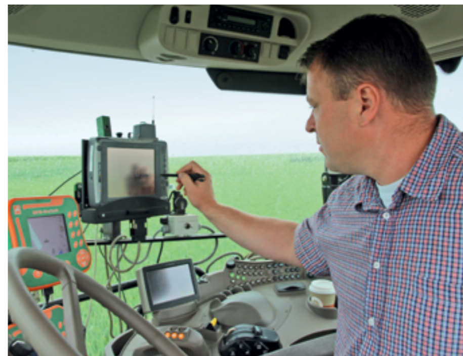
BEDIENUNG Marco Gemballa stellt das Sensor-Terminal für die anstehende N-Düngung im Mais ein. Mithilfe des Sensors kann er den Bestand früher düngen und das N-Saldo besser kontrollieren.
