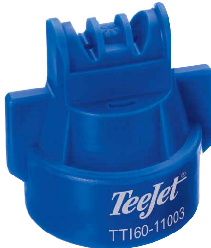
Die neue Doppelflachstrahldüse TTI160 soll durch den Twin-Effekt mit jeweils 30 Grad nach vorn und hinten einen höheren Bedeckungsgrad und eine verstärkte Durchdringung dichter Bestände bei gleichzeitig minimaler Abdrift bieten.
