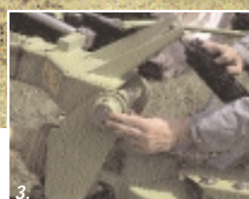
Verantwortlich für die gute Geländeanpassung: 1. Vier-Rad-Fahrwerk, 2. Kurzer Abstand zwischen Rad und Zinken, 3. Drehgelenk mit Entlastungsfedern.
