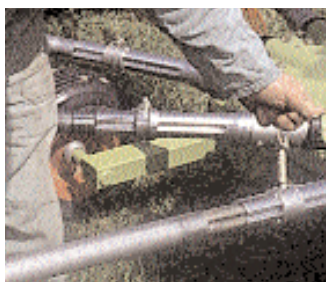
Die Zinkenarme lassen sich selbst in der zweiten Saison ohne Kraftanstrengung herausziehen.
