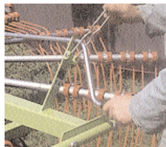
Die Höhenverstellung der Kreisel erfolgt über die Kurbel außerhalb des Gefahrenbereichs.
