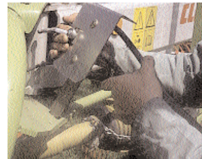
Lobenswert: Selbst für die Steuereinheit der Kreiselhebung ist eine Halterung vorgesehen.
