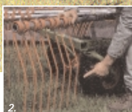
Verantwortlich für die gute Geländeanpassung: 1. Vier-Rad-Fahrwerk, 2. Kurzer Abstand zwischen Rad und Zinken, 3. Drehgelenk mit Entlastungsfedern.
