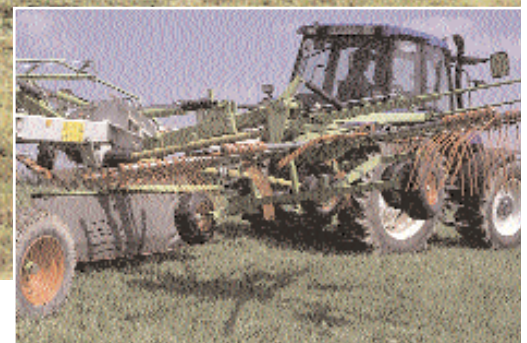
Die beiden Kreisel werden zum Überfahren von Schwaden weit und schnell genug ausgehoben.
