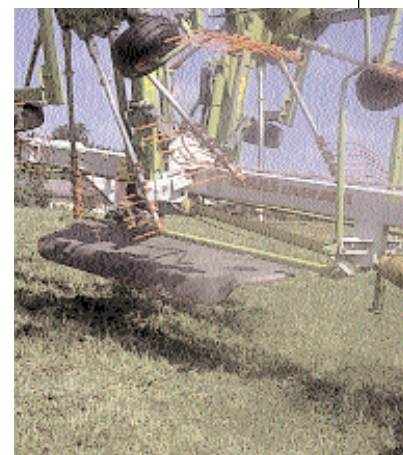
Das Schwadtuch wird mittels Gestänge beim Aufstellen der Kreisel automatisch hochgeklappt.
