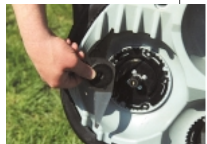
Der Messerwechsel ist ruck-zuck erledigt – ein Druck auf die Laschen an der Schneidenbasis genügt. Schutzhandschuhe tragen, da die Klingen rasiermesserscharf sind!
