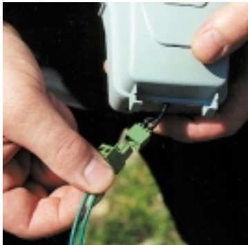
3. Schritt: Die abisolierten Enden des Begrenzungsdrahtes mit dem Begrenzungsschalter verbinden und diesen an einer wind- und wettergeschützten Wand anschrauben.
