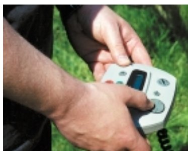
Zur Inbetriebnahme, zur Ansteuerung der Ladestation oder auch für Mäharbeiten außerhalb der abgesteckten „Grenzen“ lässt sich das Gerät per Handsteuerung bewegen.
