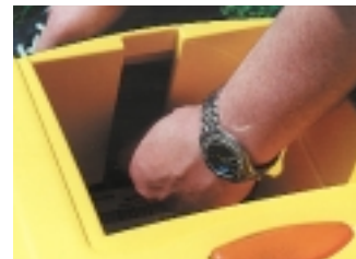
Nach dem Herausnehmen der Batterie wird die gewünschte Schnitthöhe gewählt.
