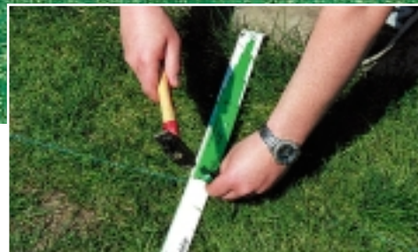
1. Schritt: Mit Hilfe einer Lehre wird zuerst der Begrenzungsdraht um die zu mähende Fläche verlegt.
