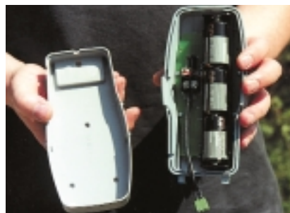
2. Schritt: Den Begrenzungsschalter öffnen und die mitgelieferten Batterien einlegen.
