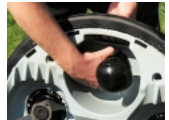
Das vordere Rad des Mähroboters kann durch Schrauben auf die jeweilige Mähhöhe eingestellt werden.
