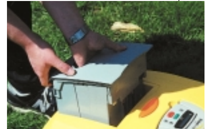
Wenn die Schnitthöhe der Hinterräder verstellt werden soll, zuerst die Batterie aus dem RL 500 entfernen.
