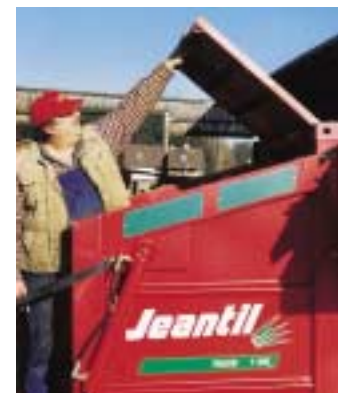
Die hydraulisch verstellbare, oben angelenkte Klappe dient zur Regulierung des Materialflusses zum Wurfrad.
