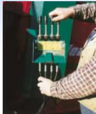
Fast alle wichtigen Gerätefunktionen – mit Ausnahme des Kratzbodenvorschubs – lassen sich per Bowdenzug vom Fahrersitz aus betätigen.
